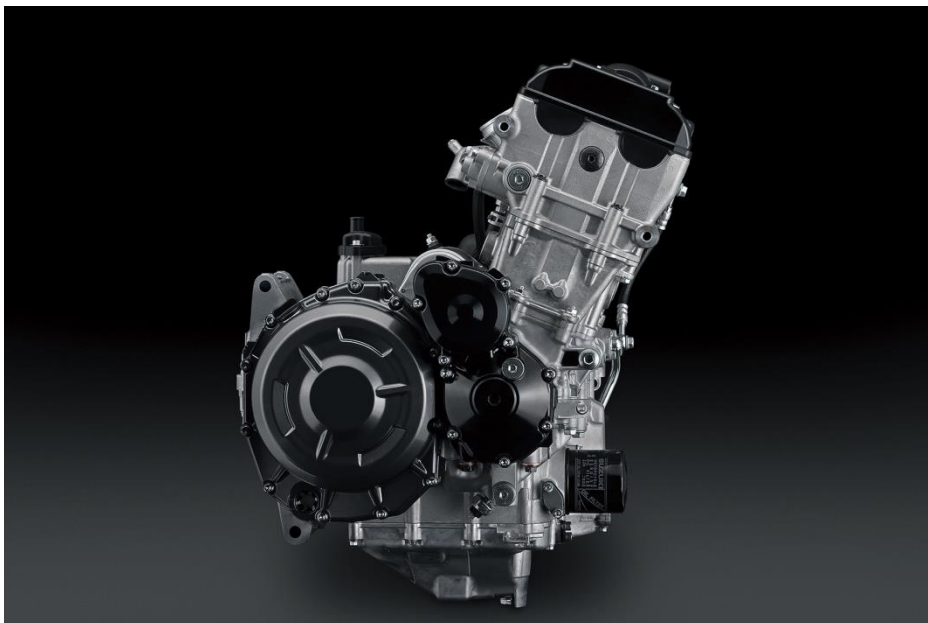
4-Takt, 4-Zylinder, flüssigkeitsgekühlt, DOHC 1340cm 3
