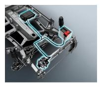
Le rendement énergétique est encore meilleur lorsqu'est intégré le système mild hybrid alimenté par une batterie lithium-ion dont la capacité a été augmentée, passant de 3 Ah à 10 Ah.
