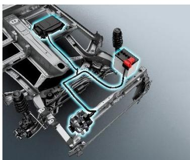
L'efficienza in termini di consumo di carburante è ulteriormente migliorata se vi è in abbinamento un sistema mild hybrid SHVS alimentato da una batteria agli ioni di litio con capacità ampliata da 3Ah a 10Ah.
