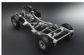
Il telaio a longheroni offre una solida base per gli elementi della sospensione quando ci si trova sullo sterrato e contribuisce a proteggere la struttura del veicolo anche sui fondi stradali più accidentati. Per la nuovissima Jimny sono stati aggiunti un nuovo «componente a x» e due componenti trasversali aggiuntivi come ulteriore rinforzo e per aumentare la rigidità torsionale.
