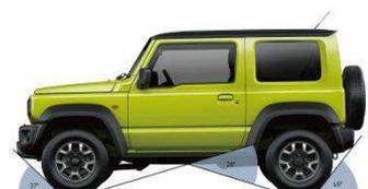
L'ampio angolo di attacco di 37°, l'angolo di dosso di 28° e l'angolo di uscita di 49° consentono alla Jimny di superare gli ostacoli e i tragitti più scoscesi, senza graffiare paraurti o sottoscocca.
