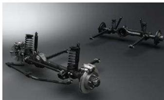
Le sospensioni ad assale rigido danno il meglio di sé nelle condizioni di guida più accidentate. Se un solo pneumatico viene sollevato da un ostacolo, lo pneumatico collegato sull'altro lato è premuto verso il basso, assicurando una maggiore aderenza sui fondi stradali sconnessi. La Jimny monta sospensioni ad assale rigido davanti e dietro, consentendo di viaggiare in tutta comodità sullo sterrato.
