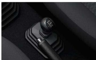
La Jimny ha un sistema 4X4 part time con cambio di gamma bassa, che può essere commutato facilmente tra le modalità 2H (2WD high-gear), 4H (4WD high-gear) e 4L (4WD low-gear) attivando una leva comandi collegata direttamente al cambio. Rispetto alla modalità 4H, la 4L può trasferire più coppia agli pneumatici a marce basse e una migliore trazione sulle pendenze e su sterrato.
